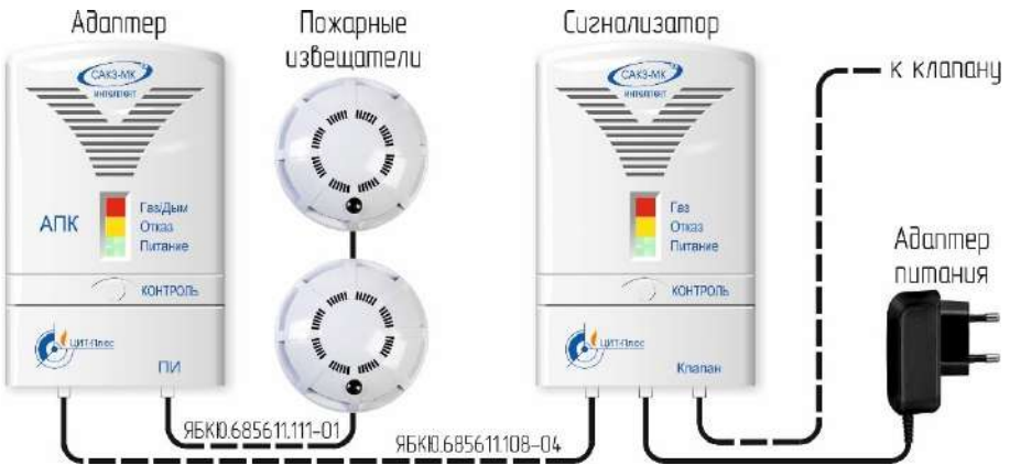
Рисунок Б.2 – Типовая схема подключения пожарных извещателей
